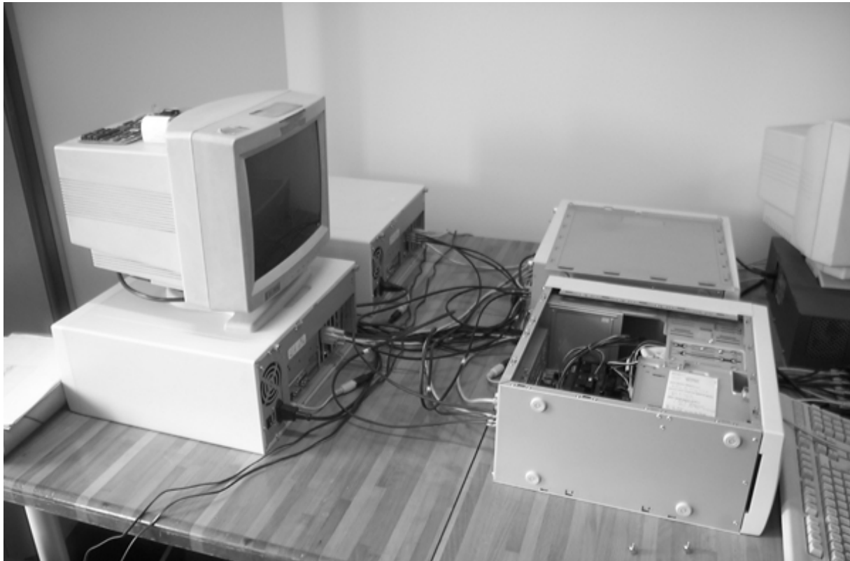
Fig. 1.1 Machine MPC en configuration 4 nœuds bi-processeurs
